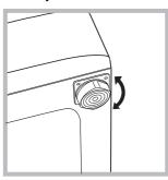
редних ножек (см. рис.). Для этого сначала ослабьте контргайку, после завершения регулировки контргайку затяните.
