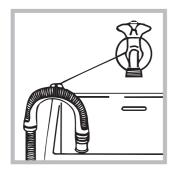
Повесьте загнутый конец сливного шланга на край раковины, ванны, ипи поместите специальный вывод канализации. Шланг не должен перегибаться. Верхняя точка сливного шланга должна находиться на высоте 65-100 см от пола. Расположение сливного шланга должно обеспечивать разрыв струи при сливе (конец шланга не должен быть опущен в воду).
